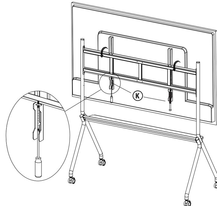
マウント用金具の下からスクリーン本体に同梱されている固定用ネジKを取り付け、ネジを締めて、スクリーン本体をしっかりと固定します。
